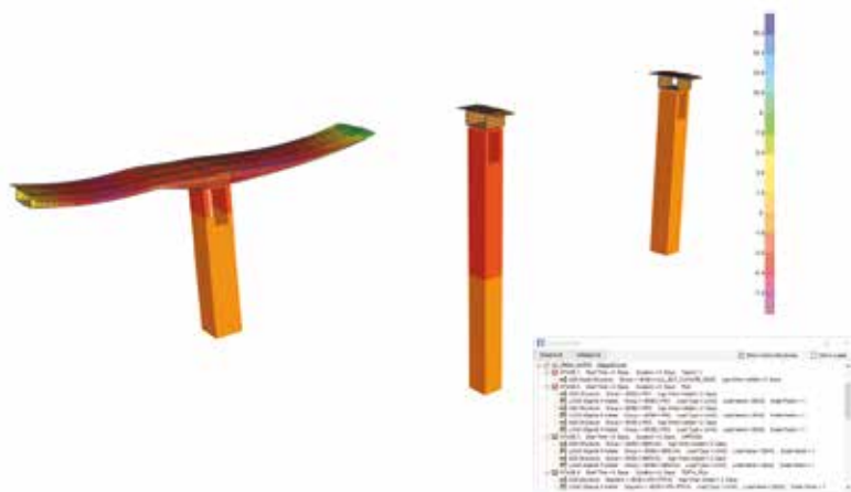
6. Lo studio della fase costruttiva con sequenza di tiro e calibratura (CSiBridge)
